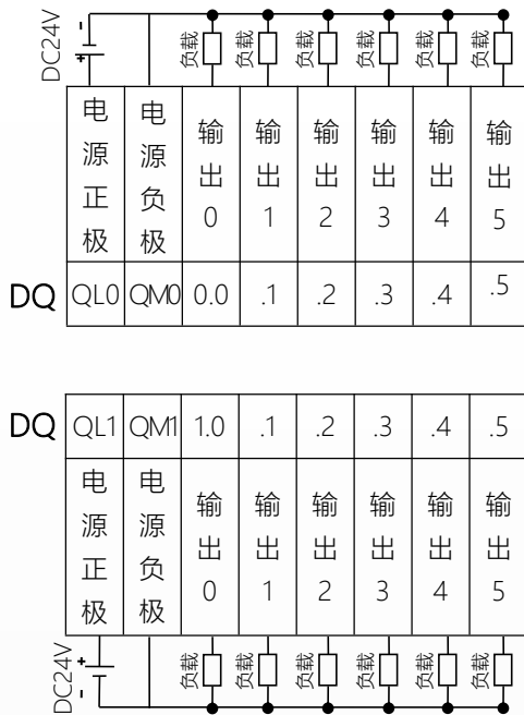
E20C1 数字量 12 点输出模块 PNP 型
