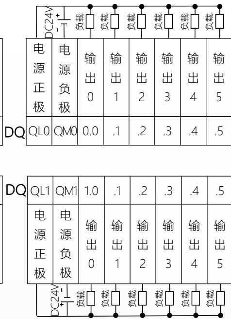
E20C2 数字量 12 点输出模块 NPN 型
